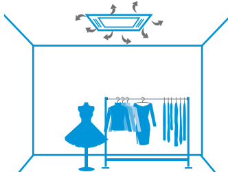
Distribuția aerului cu un filtru murdar
